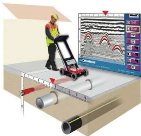
Esempio: Indagine georadar di sottoservizi
