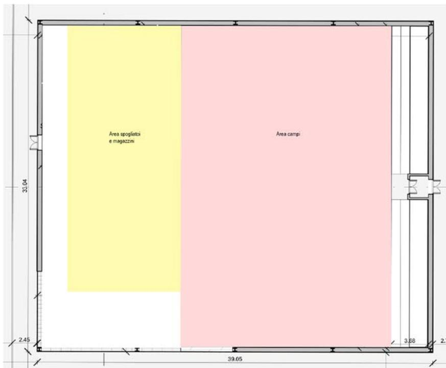
L'involucro dell'edificio sarà caratterizzato da ampie vetrate, con sistemi schermanti, tali da garantire una illuminazione naturale almeno pari ad 1/10 della superficie dell'area di gioco. Il ricambio di aria sarà garantito da impianti di ventilazione meccanica con recupero di calore. Gli spogliatoi avranno finiture e dotazioni impiantistiche in linea con la normativa vigente.
