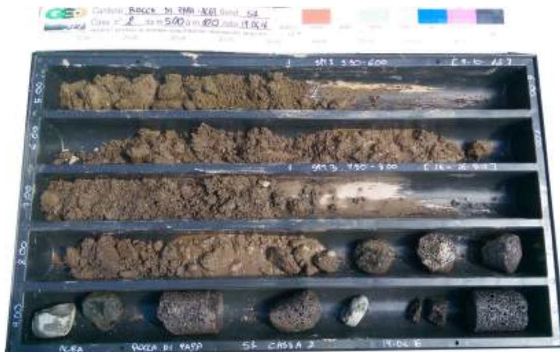
Sondaggio 1 Cassetta 2 da mt 5.00 a mt 10.00
