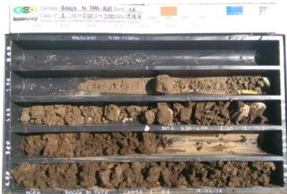
Sondaggio 1 Cassetta 1 da mt 0.0 a mt 5.00
